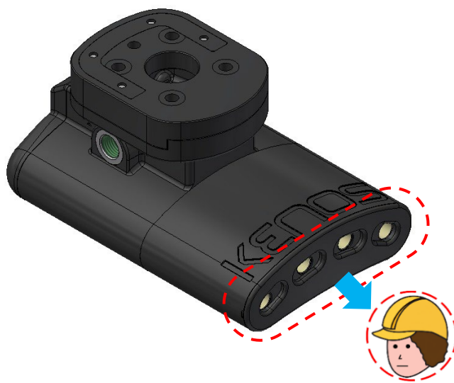
Rysunek 8: Przepływ powietrza wylotowego.
